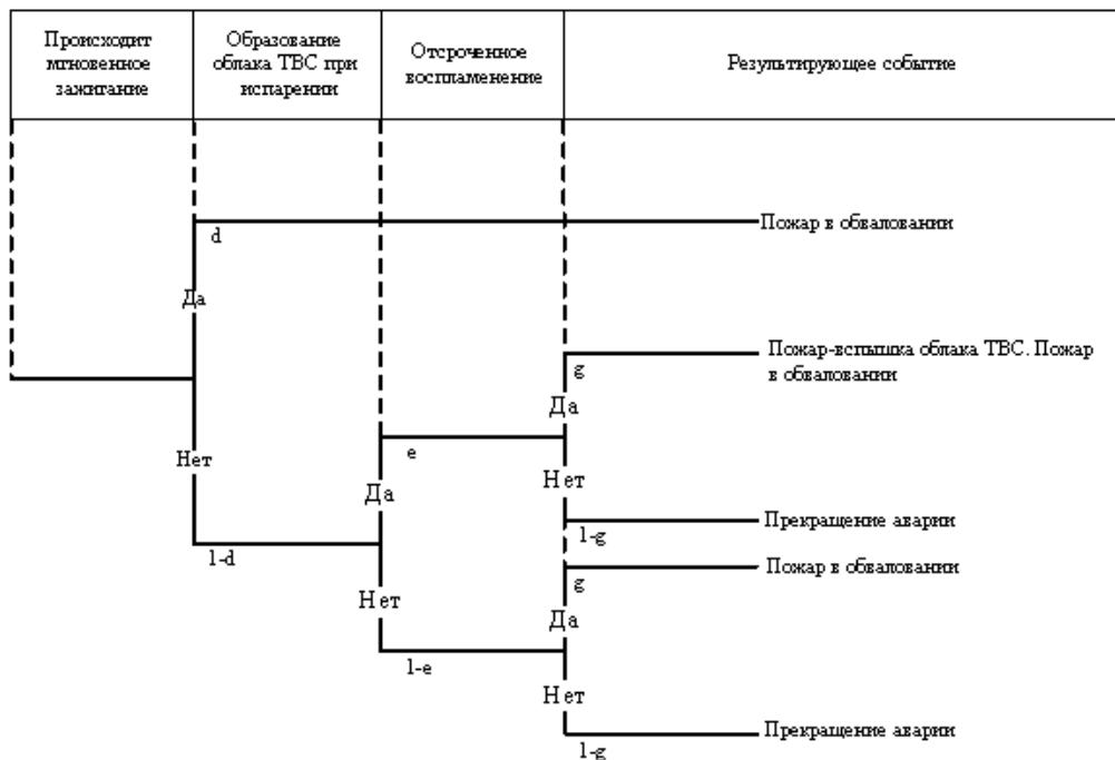
Рис. 4 "Дерево событий" разрушения/перелива подземного резервуара (сценарий A<sub>4</sub>)
