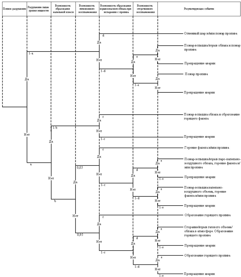
Рис. 7 "Дерево событий" при разрушении емкости под давлением (сценарий А<sub>7</sub>)
